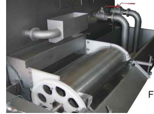
Cabezal abatible para un mejor acceso a las agujas
